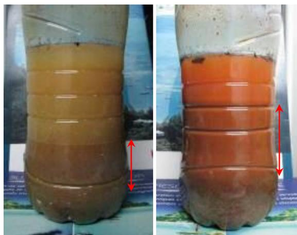
Figure 7. Détermination « de manière approximative » des proportions d'argiles / à gauche prélèvements issus des sols (silt-)gréseux et à droite issus des filons de serpentinites – la flèche rouge donne la hauteur de la couche d'argile.
