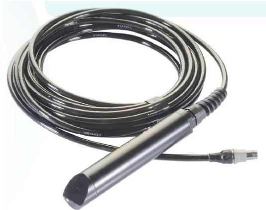
Figure 21. Exemple de capteur de turbidité (capteur Poncel ; source site internet d'Aqualabo,)
