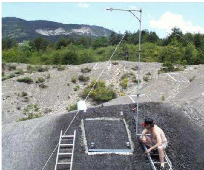
Figure 19. Dispositif de simulation de pluie (source : MATHYS, 2006)
