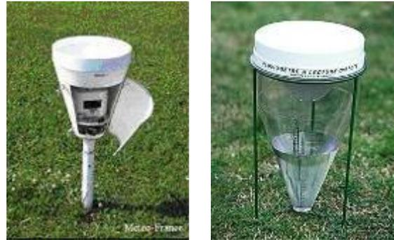
Figure 13. Pluviomètre à augets basculeurs et total
