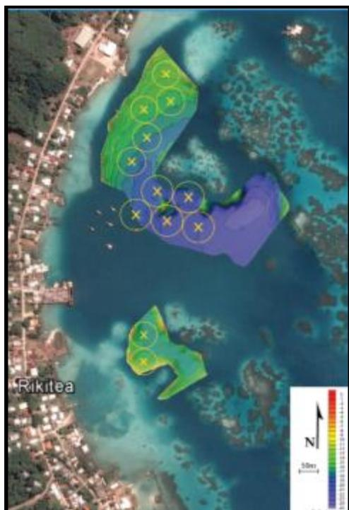
Figure 6 : Propositions de positionnement des mouillages dans la rade de Rikitea (et bathymétrie) (©Créocéan)
