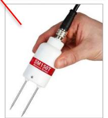
Figure 14 : sonde d'humidité et température DELTA SM150 T / implantation sur SAV
