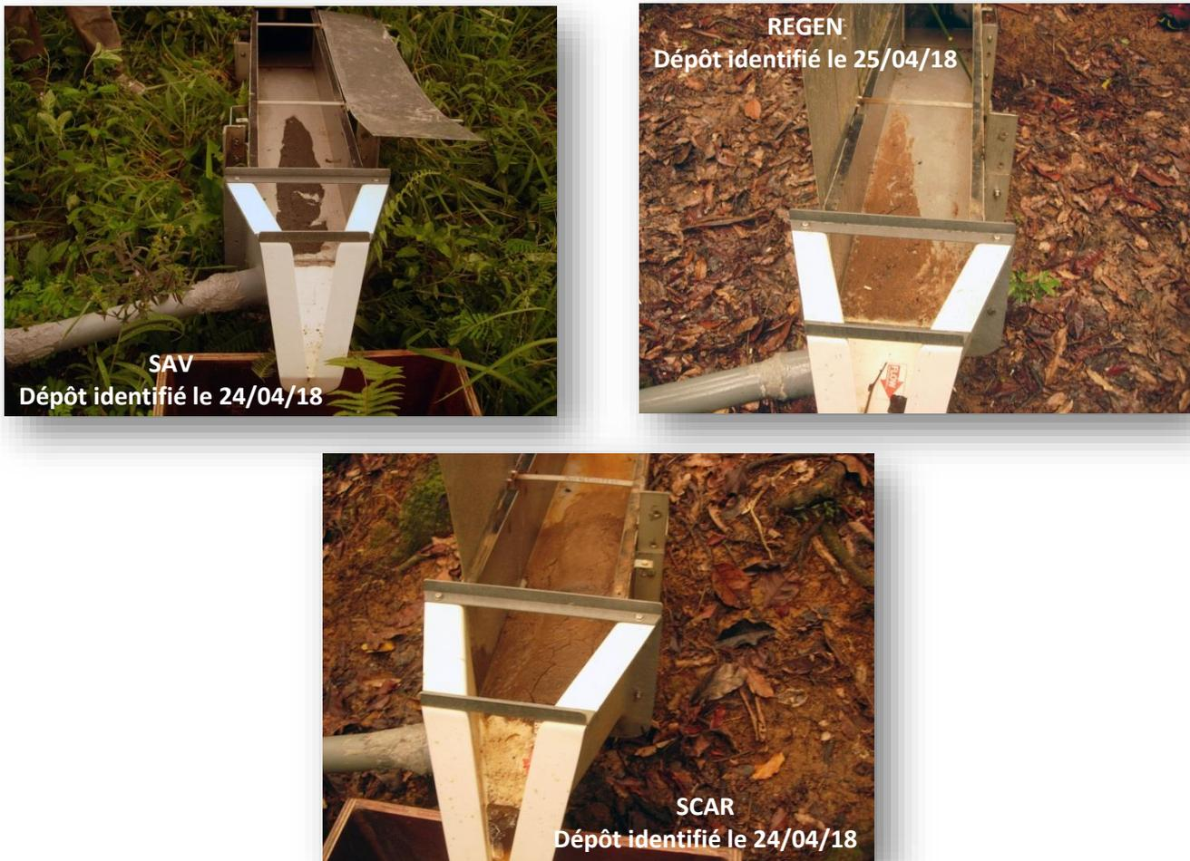
Figure 21: Dépôt sédimentaire dans les canaux d'approche lors du relevé d'avril 2018 pour REGEN, SCAR et SAV
