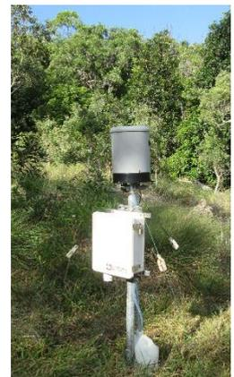
Figure 15 : pluviomètre sur REGEN
