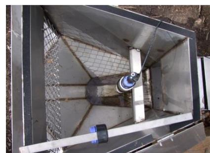
Figure 13 : vue de la sonde avec l'embout dévissé / installation dans le collecteur
