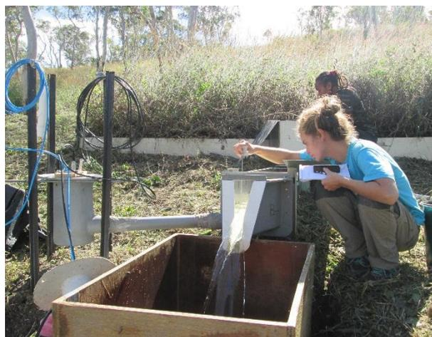
Figure 12 : sondes Trublue Paratronic dans le puits de mesure – essai de controle des valeurs
