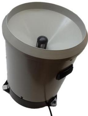
Le CS701 entonne les précipitations dans un mécanisme d'auget qui bascule quand il est rempli à son niveau étalonné. Chaque basculement est marqué par une double fermeture à clapet qui est enregistrée par un canal de comptage d'impulsions. Après la mesure, l'eau s'écoule à travers deux orifices (accepte un tube de 12 mm) dans la base, ce qui permet de recueillir l'eau mesurée dans un récipient séparé.
