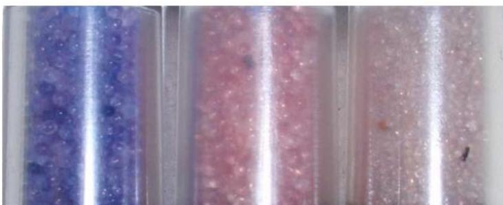
Figure 21: Code couleur mettant en évidence la durée de vie du dessiccateur
