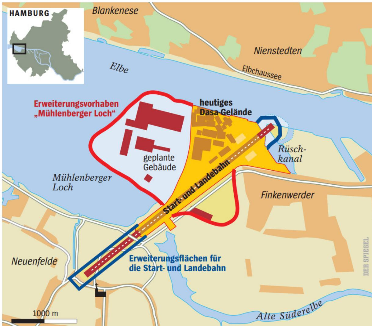
**Bild 12:** Die Startbahn bei 3500 m Länge. Die rot gekennzeichnete Verlängerung nach Südwesten beträgt heute nur etwa die Hälfte. Die Startbahn hat heute eine Länge von 3183 m.
