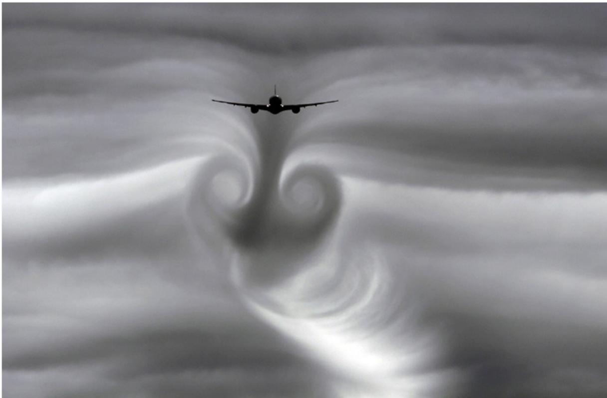
**Bild 6:** Jedes Flugzeug besitzt eine Wirbelschleppe, die sich ausgehend von den beiden Flügelspitzen in der Form von zwei Wirbelzöpfen ausbildet.
