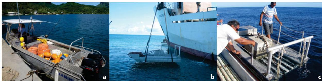
Figure 6. Un des deux petits bateaux en aluminium (a) utilisés pour transporter le mouillage et les flotteurs et le catamaran-plateforme (b et c) utilisé pour le transport du corps-morts en Polynésie française (photos : Mainui Tanea).
