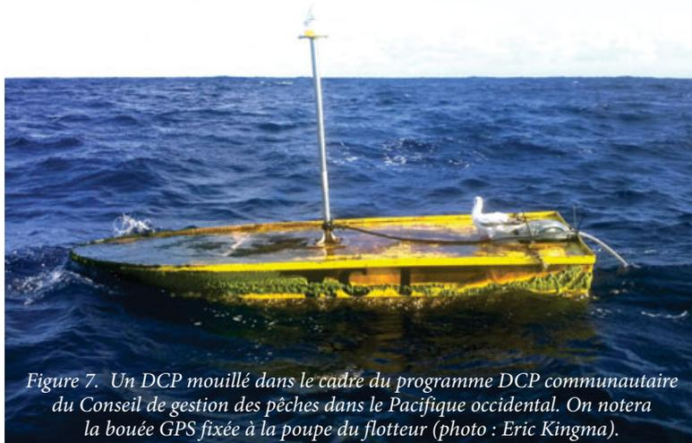
Figure 7. Un DCP mouillé dans le cadre du programme DCP communautaire du Conseil de gestion des pêches dans le Pacifique occidental. On notera la bouée GPS fixée à la poupe du flotteur (photo : Eric Kingma).
