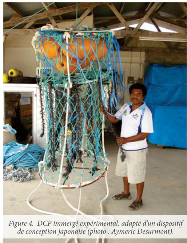
Figure 4. DCP immergé expérimental, adapté d'un dispositif de conception japonaise (photo : Aymeric Desurmont).
