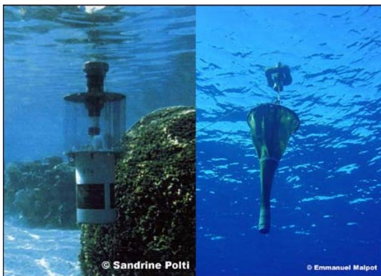
**Figure 4.** Light-trap Aquafish Technology (à gauche) dans le lagon de Moorea (Extrait de Polti 2001) et light-trap Ecocean (système C.A.R.E) en sub-surface à Rangiroa (Extrait de Malpot 2005)
