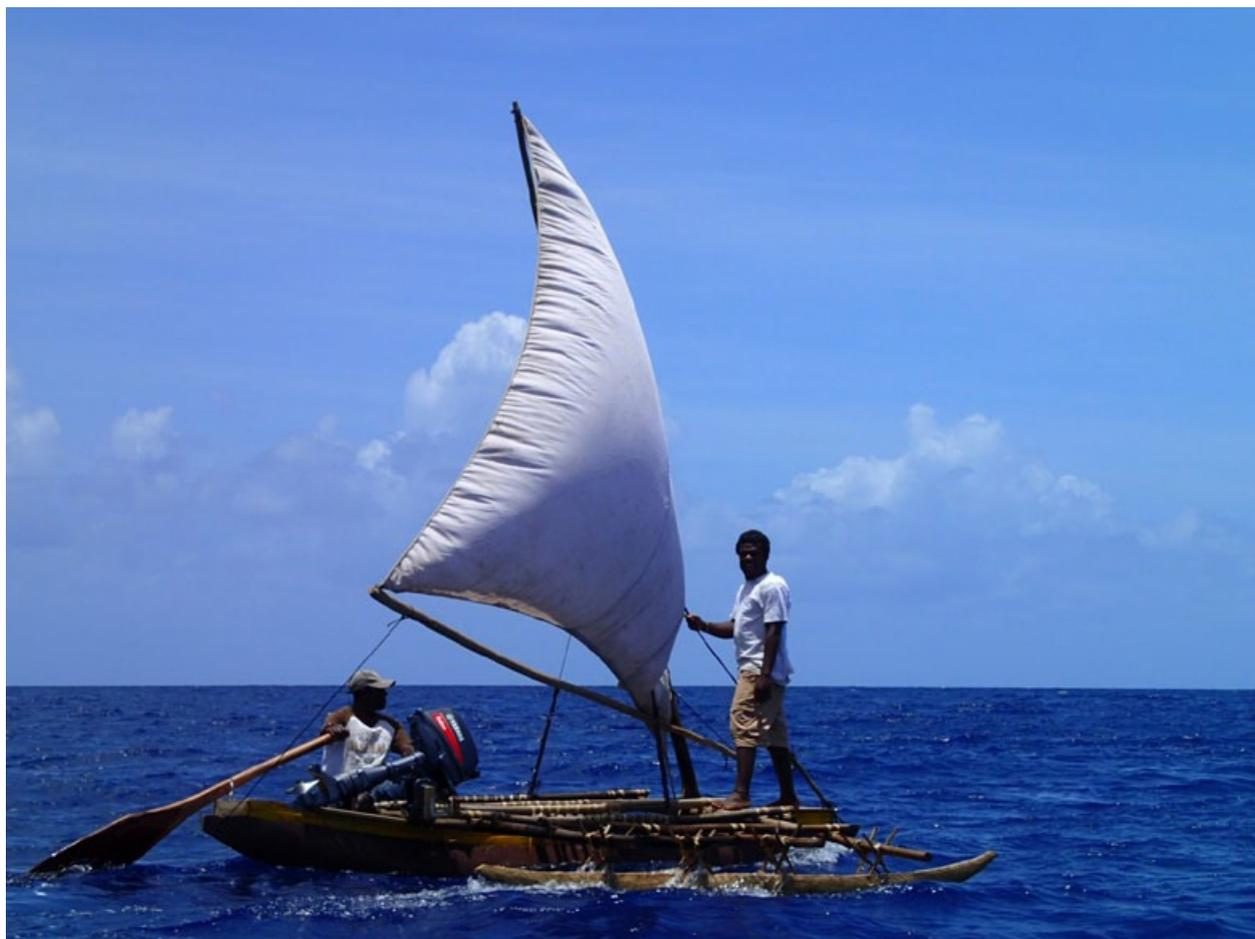
**Photo 7.** Essai en mer de la pirogue modifiée qui prouve qu'avec un bon vent, les pêcheurs ne sont plus tributaires des moteurs hors-bord.
