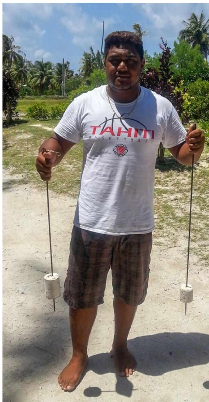
Figure 4. Exemples de « torpilles » fabriquées en béton coulé dans des boîtes de conserve.
