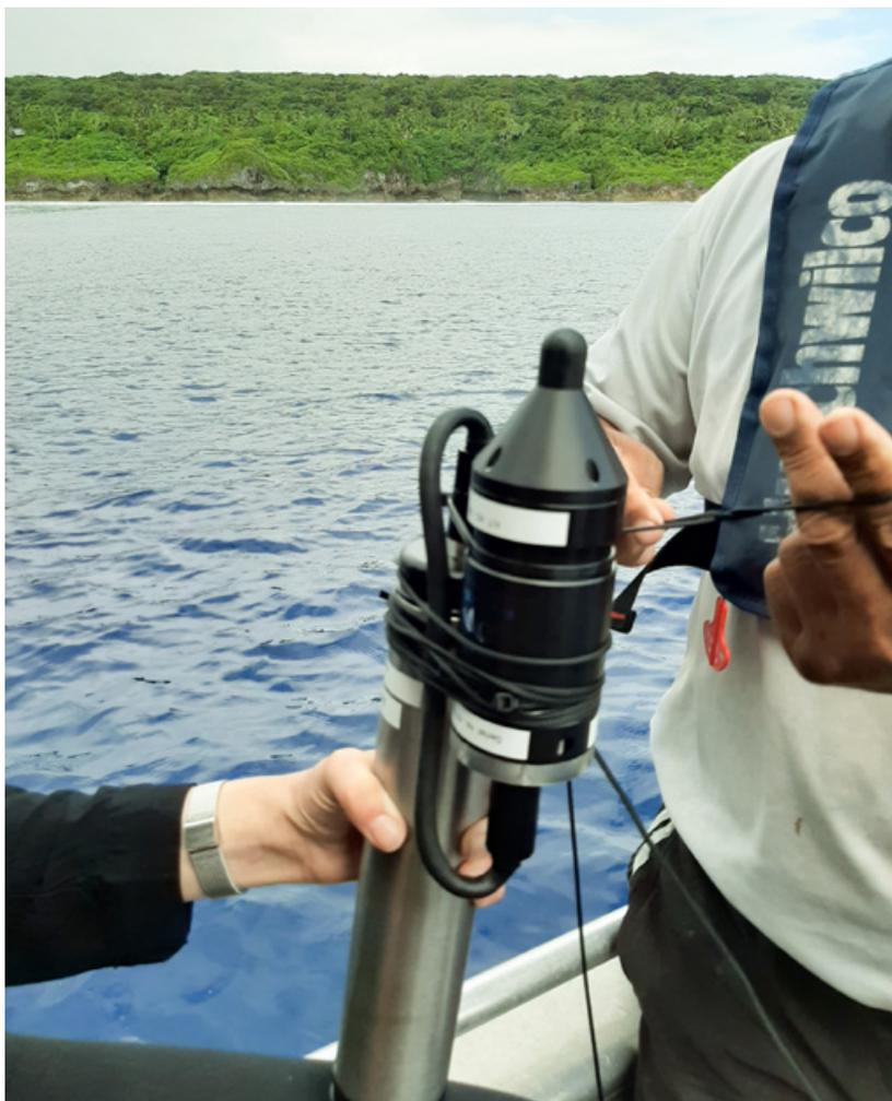
Un hydrophone prêt à être installé à Niue.
