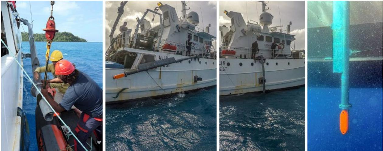
Figure 3. Un échosondeur de surface est installé sur le côté du N/O *Alis* pour observer les organismes dans la première tranche de 10 m sous la surface. Images: Valérie Allain
