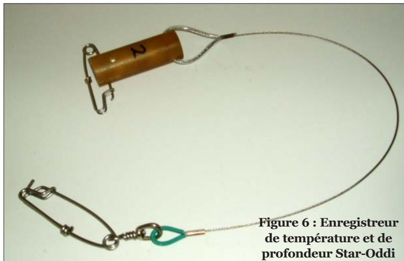
Figure 6 : Enregistreur de température et de profondeur Star-Oddi
