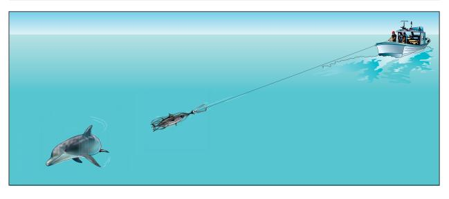
Un poisson est ferré. Le bateau continue d'avancer. L'effaroucheur est accroché sur la ligne de traîne (1 et 2) et glisse le long de la ligne (3) pour couvrir le poisson. Le dauphin est repoussé par les «franges » métalliques (4). Illustrations par Jipé Le-Bars, CPS.
