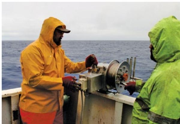
Figure 3. Un enrouleur NKAF-3A monté sur la hanche tribord du navire de pêche Bai Ni Takali.
