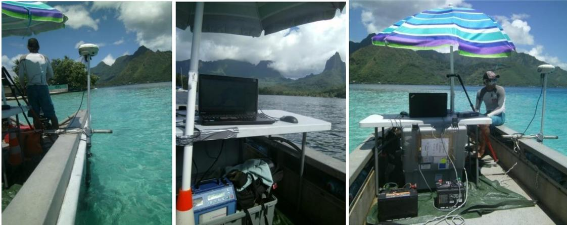
Figure 24 : Matériel utilisé pour les levés bathymétriques dans la baie d'Opunohu
