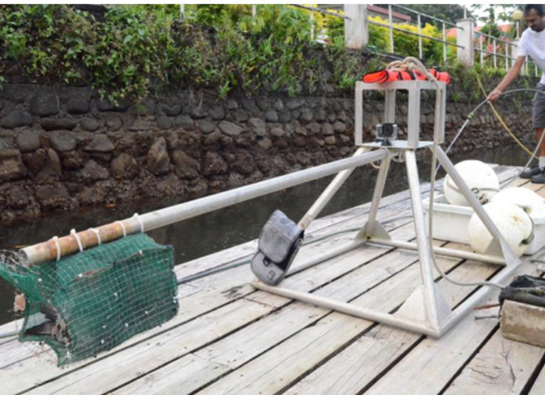
Préparation d'un système de vidéo sous-marine appâté et contrôlé à distance, Pacific Harbour, Viti Levu (Fidji). Ce type de système permet de surveiller le milieu marin à l'aide d'appâts destinés à attirer le poisson dans le champ d'une caméra vidéo. (Crédit photo : Marcel Keurmtjes / WWF-Pays-Bas)
