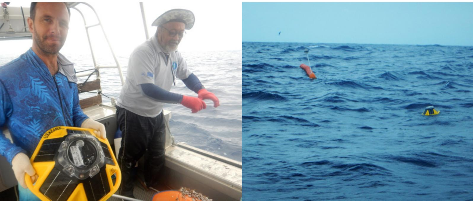
Figure 1. À gauche : Adrien Moineau et William Sokimi connectent la bouée houlographe au DCP. À droite : La bouée houlographe dépassant à peine la surface est attachée au DCP et commence à transmettre des données. (Crédit photo : ©CPS)
