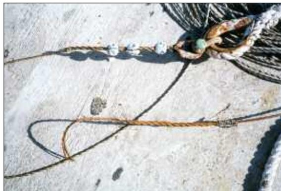
**Figure 5 : Oeil épaissi rouillé et cassé sur le câble métallique de la partie supérieure d'un DCP**
